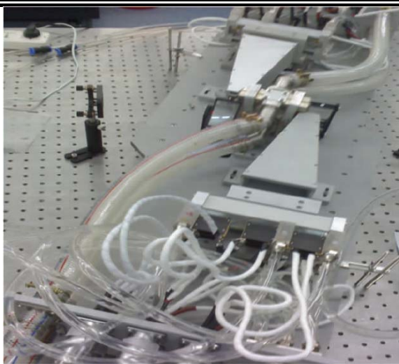
图 1.8 传导冷却端泵浦的 Nd:YAG 板条模块
