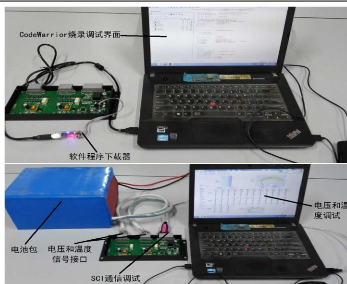
图 5.13 前期 BTMS 软件调试和硬件测试
