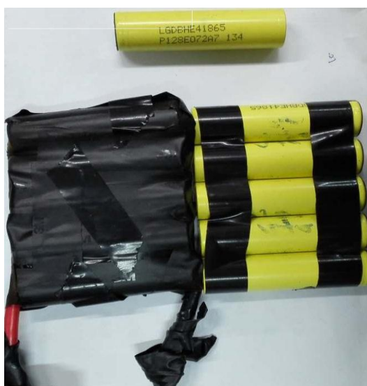
图 5.2 电池单体和模块实物图
