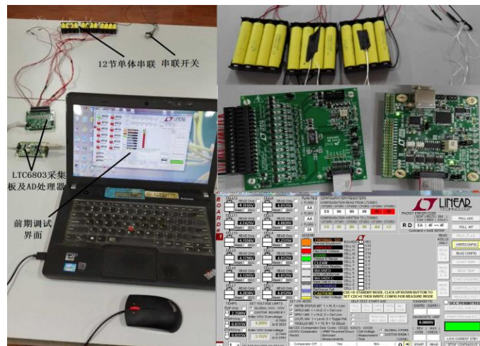
图 5.12 前期 LTC6803 电压检测调试
