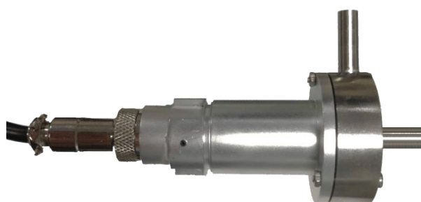
图 3-6 驱动源微型泵实物图
