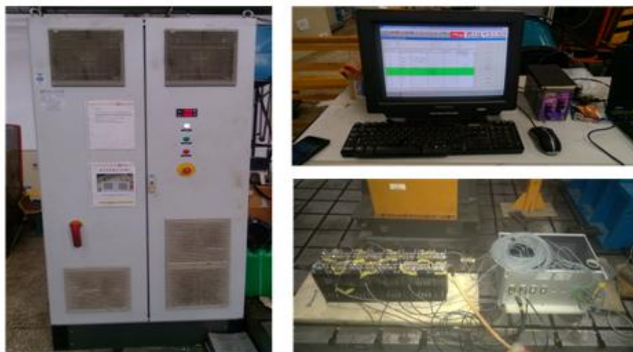
图 2.5 磷酸铁锂电池充放电温度监测实验
