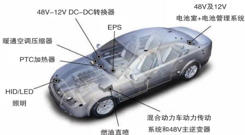
图 1.1 48V 电源在汽车高功率系统中的应用
