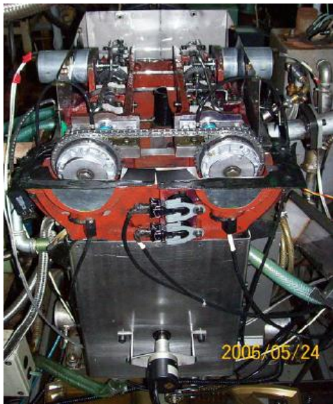
图 2-3 4VVAS 单缸原理样机实物图
