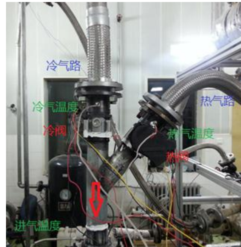
图 2-5 进气热管理系统实物图
