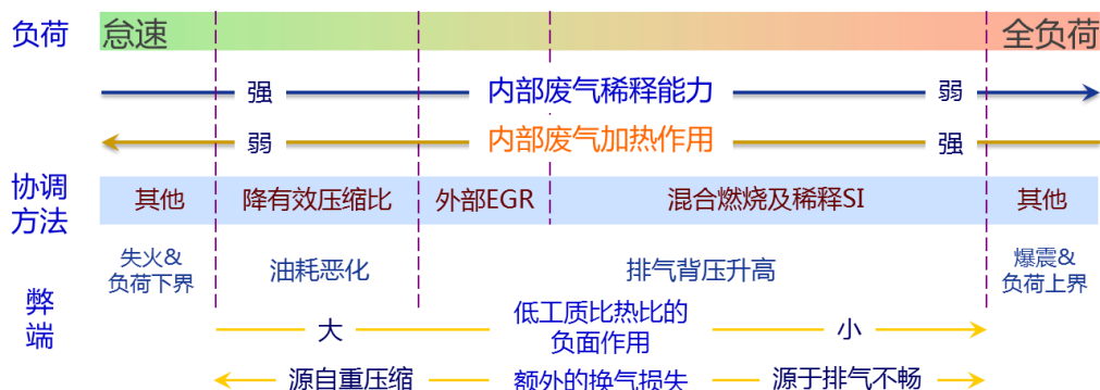
图 1-3 基于废气管理的低温高效燃烧的原理与不足
