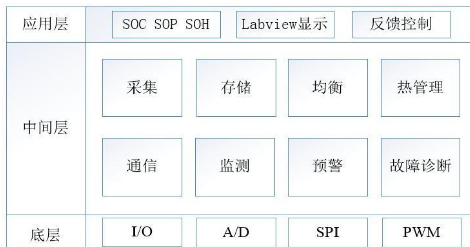
图 4-1 BMS 软件系统架构
