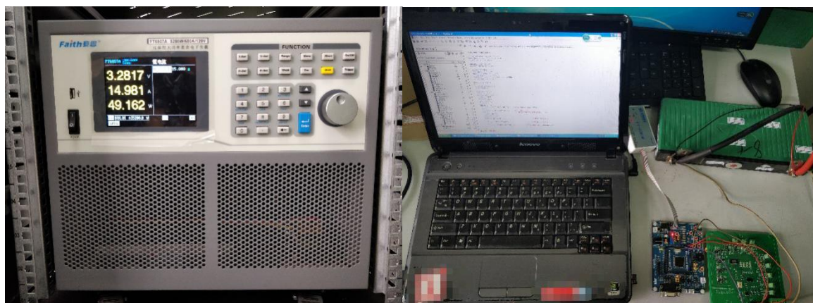
图 6-1 BMS 硬件测试平台
