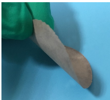
图 2-17 剥离的 h-BN@PDA/CNC 复合材料的弯曲图片
