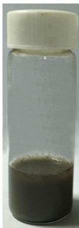
图 2-2 剥离的 h-BN@PDA 分散液的光学图片
