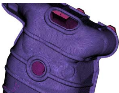
图 3-3 发动机排气管隔热罩表面网格
