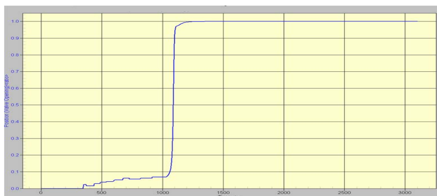
图 5-18 90Km/h 工况下节温器开度曲线
