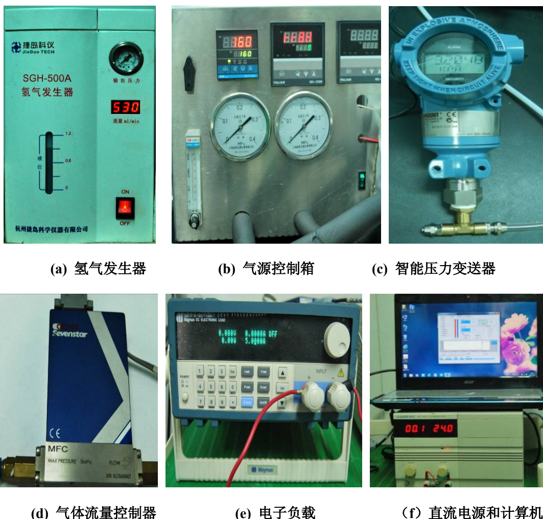
图 5-7 测试平台主要设备实物图
