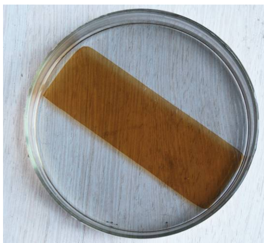
图 5-2 酸化处理的 PBI 膜
