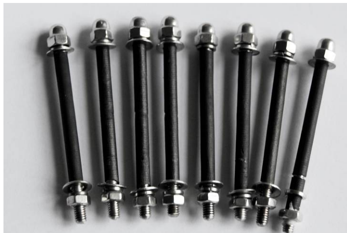
图 5-4 套有热缩管的 M4 螺栓
