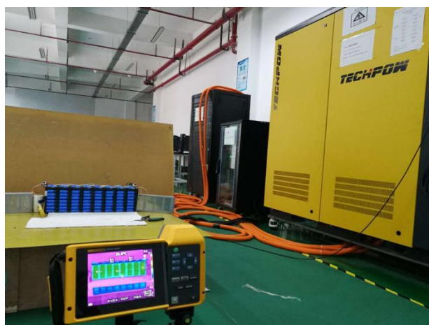
图 4.7 电池组温升特性试验平台
