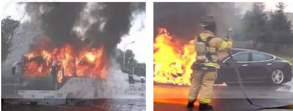
图 1-2 电池热失控造成的爆燃
