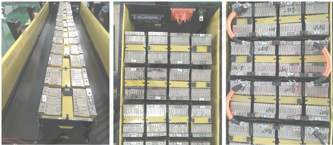
图 4-5 软包电池模组平行排列方式
