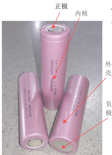
图 3-10 18650 型号圆柱电池外形
