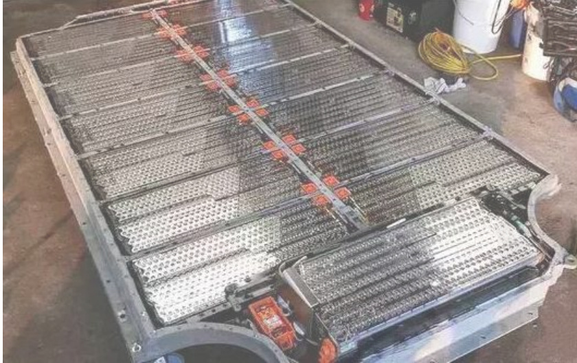
图 4-2 特斯拉 Model S 电动汽车电池组板
