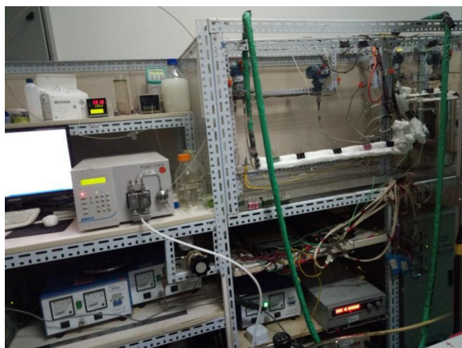
图 3.1 流动型比热容实验系统实物图
